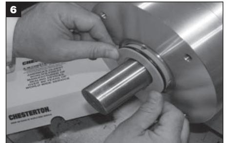
6 Retire el calzo y presione uniformemente el sello en el interior del orificio.
