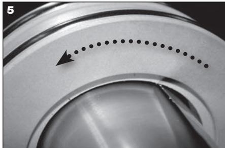
5 Rote el sello en dirección del solapado del calzo para y deslícelo sobre el eje.
